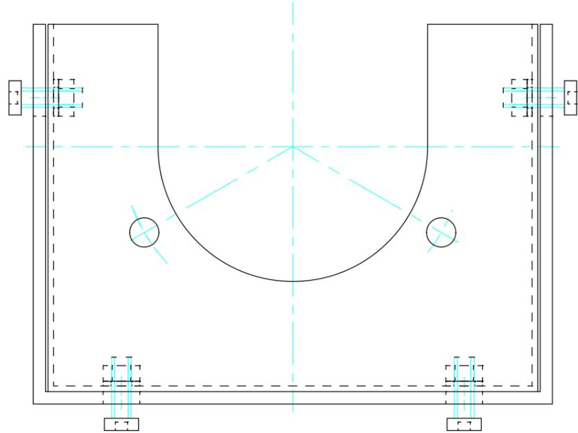
1000 kN圧縮試験機時にテストピースが爆裂飛散を防止するために
